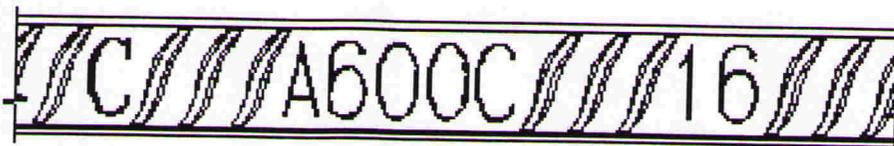
При нормативном сопротивлении  $R_{sp}=600\text{Н/мм}^2$  расчетные сопротивления для предельных состояний первой группы составляют:  $R_s = 520\text{ Н/мм}^2$ ,  $R_{sc} = 470\text{ Н/мм}^2$ . Применение арматурной стали класса А600С взамен арматурной стали
